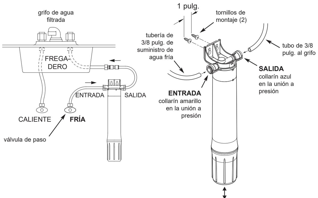
**NOTA:** No olvide dejar un espacio mínimo de 1-1/2 pulg. debajo del sistema a fin de retirar el cartucho filtrante para cambiarlo.
