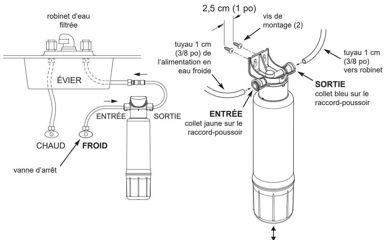
**REMARQUE :** Prévoir un dégagement minimum de 3,8 cm (1 ½ po) sous le système (retrait et remplacement de la cartouche filtrante).
