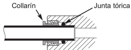
Tubo totalmente acoplado a la unión FIG. 21
