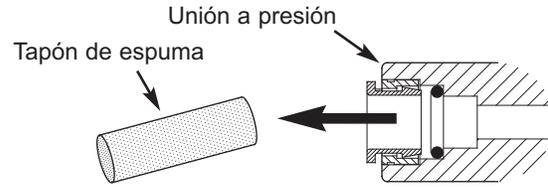
Retire y elimine los tapones de espuma FIG. 18
