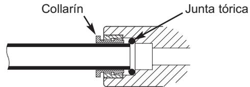
Tubo parcialmente acoplado a la unión FIG. 20
